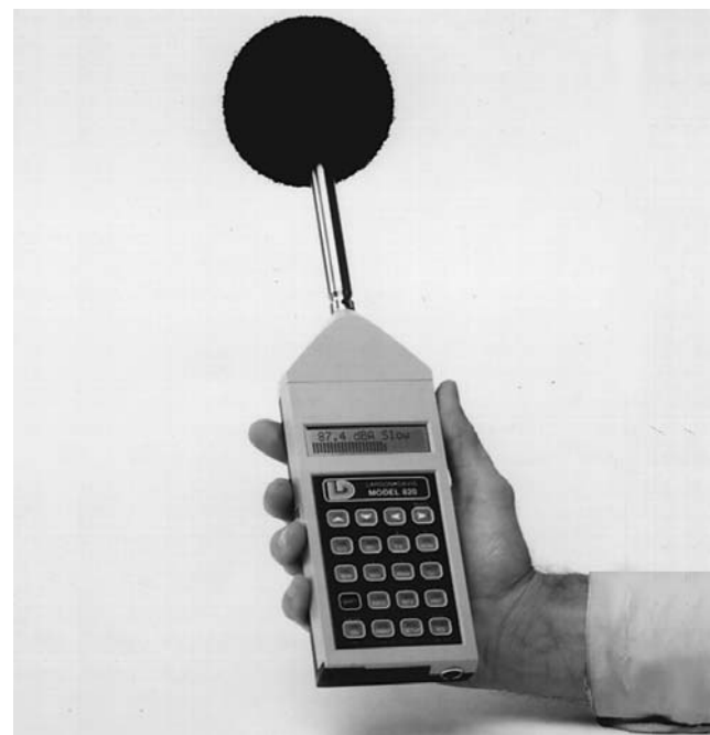
Figure 47.3 • Sonomètre équipé d'une boule pare-vent.
