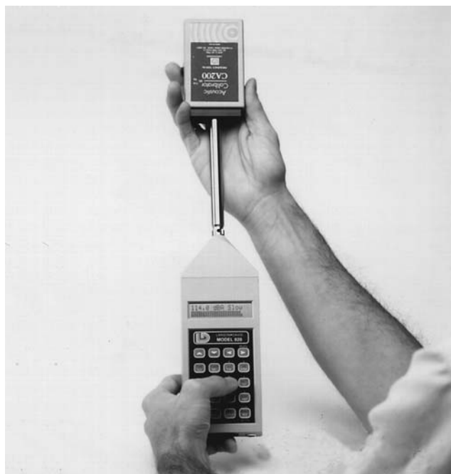
Figure 47.2 • Sonomètre: vérification de l'étalonnage.
